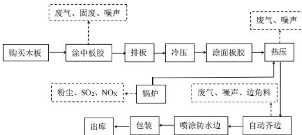
图 2-2 胶合板生产工艺流程及产污节点图
