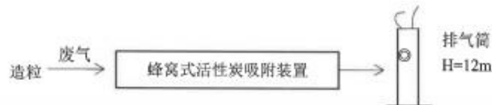
图 1：有组织废气处理工艺流程及监测点位示意图
